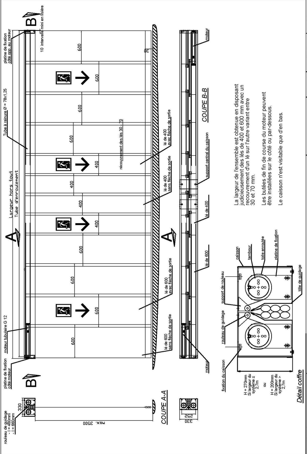
La largeur de l'ensemble est obtenue en disposant judicieusement des lés de 400 et 600 mm avec un recouvrement d'un lé sur l'autre variant entre 30 et 70 mm.
